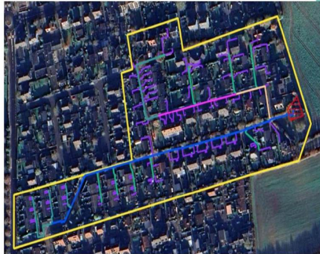
Abbildung des bestehenden Wärmenetzes in Wattenbek
